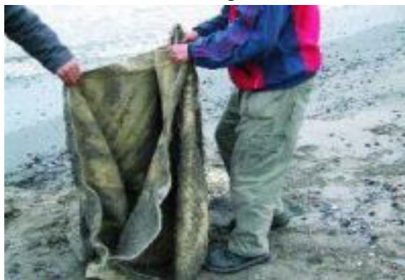
Figura 45. Degradarea prin rupere a cusăturii [15]
