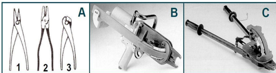
Figura 5. Tipuri de clești utilizați la prinderea capselor [3]
