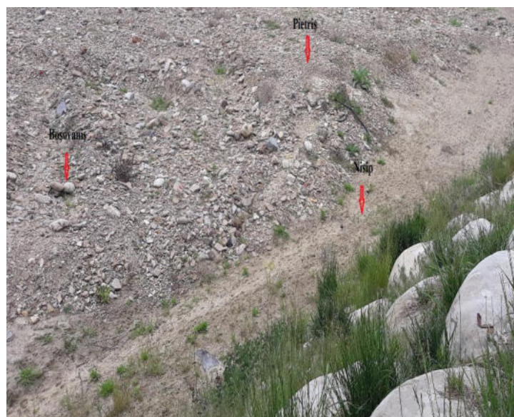
Figura 69. Compoziția granulometrică a depozitului de aluviuni (foto autor)
